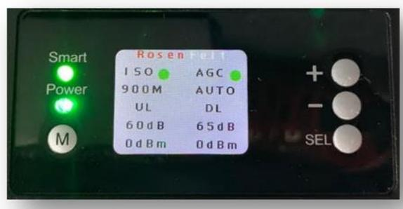
1. Tras encender el repetidor, la luces de “Power” y de “ISO” en el display deberán aparecer encendidas en verde. Si no es así, el repetidor no recibe corriente.
