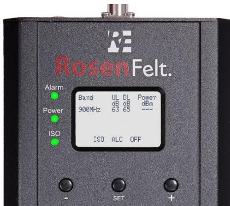
Los repetidores modelo 5 están equipados de fábrica con AGC (Automatic Gain Control). Esto permite que el repetidor se auto configure de la manera más óptima. Algunas veces, esto no es posible, entonces **la luz "ISO" parpadea**. En ese caso, presione el botón "SET". De esta manera podrá ver que bandas están causando el problema.
